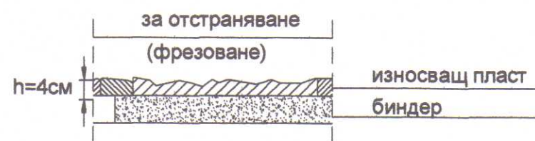
ДЕТАЙЛ No1 - Фрезование на повредени площи
